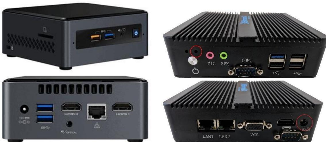
O Intel tem na parte frontal duas entradas USB, um botão já com o LED de liga/desliga e na parte traseira tem uma entrada de alimentação 19V, duas entradas USB, duas entradas HDMI e uma entrada de rede para conector RJ45. Na lateral direita há uma entrada para cartão SD.
